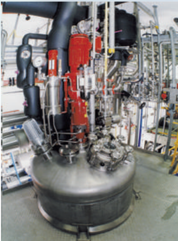
Mischbehälter für Hoch- und Tieftemperaturreaktionen
