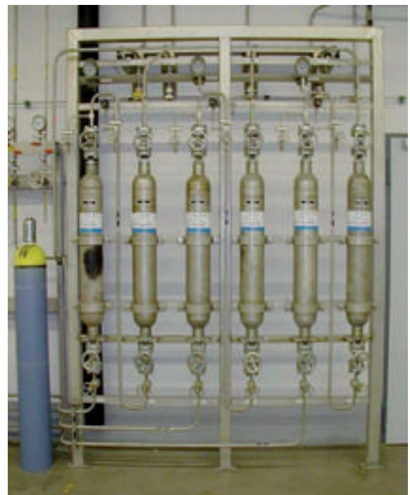
Abb. 11: Oxisorb®-Reinigungsstation zum gezielten Entfernen von Spuren an Wasser und Sauerstoff
