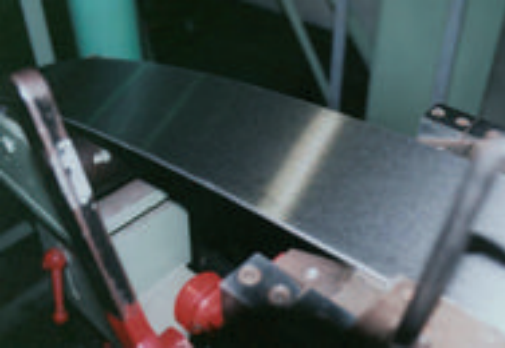
Abb. 5: Sintern von Bronzepulver auf Stahlband unter kontrolliertem Stickstoff/Wasserstoff-Schutzgas
