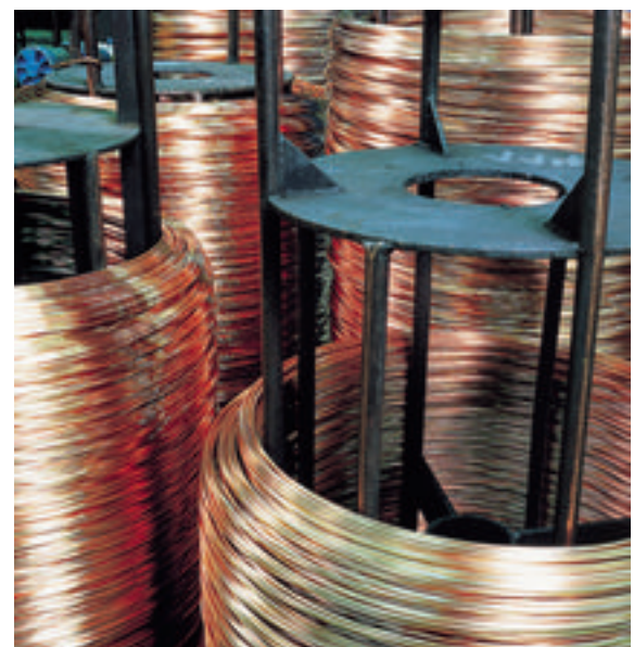
Abb. 6: Im Haubenofen geblühte Kupferrohre
