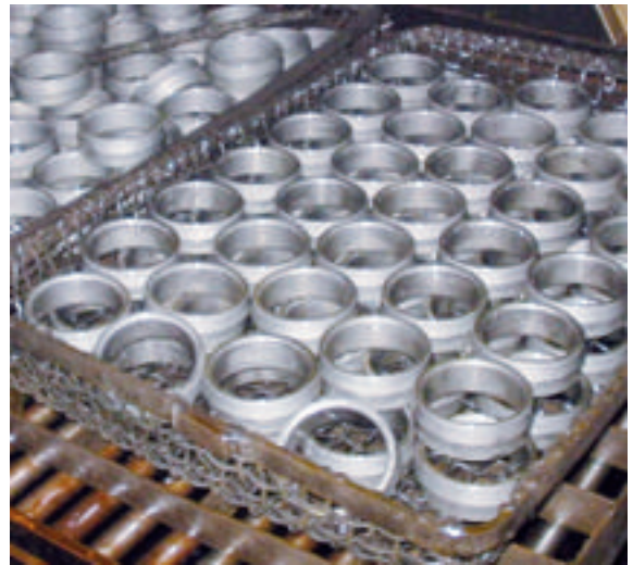
Das Härten ist ein wichtiger Teilschritt Fertigungsprozess: Gehärtete Lagerringe nach dem Härtebad.
