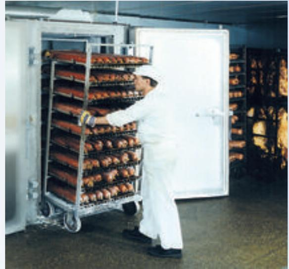
Abb. 8: Für chargenweisen Betrieb und Frostleistungen von 100 bis 1000 kg/h: der Cryogen-Rapid®-Schrankfroster
