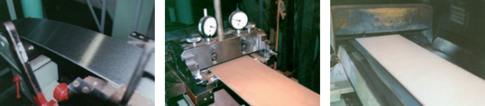
Abb. 5: Sintern von Bronzepulver auf Stahlband unter kontrolliertem Stickstoff/Wasserstoff-Schutzgas
