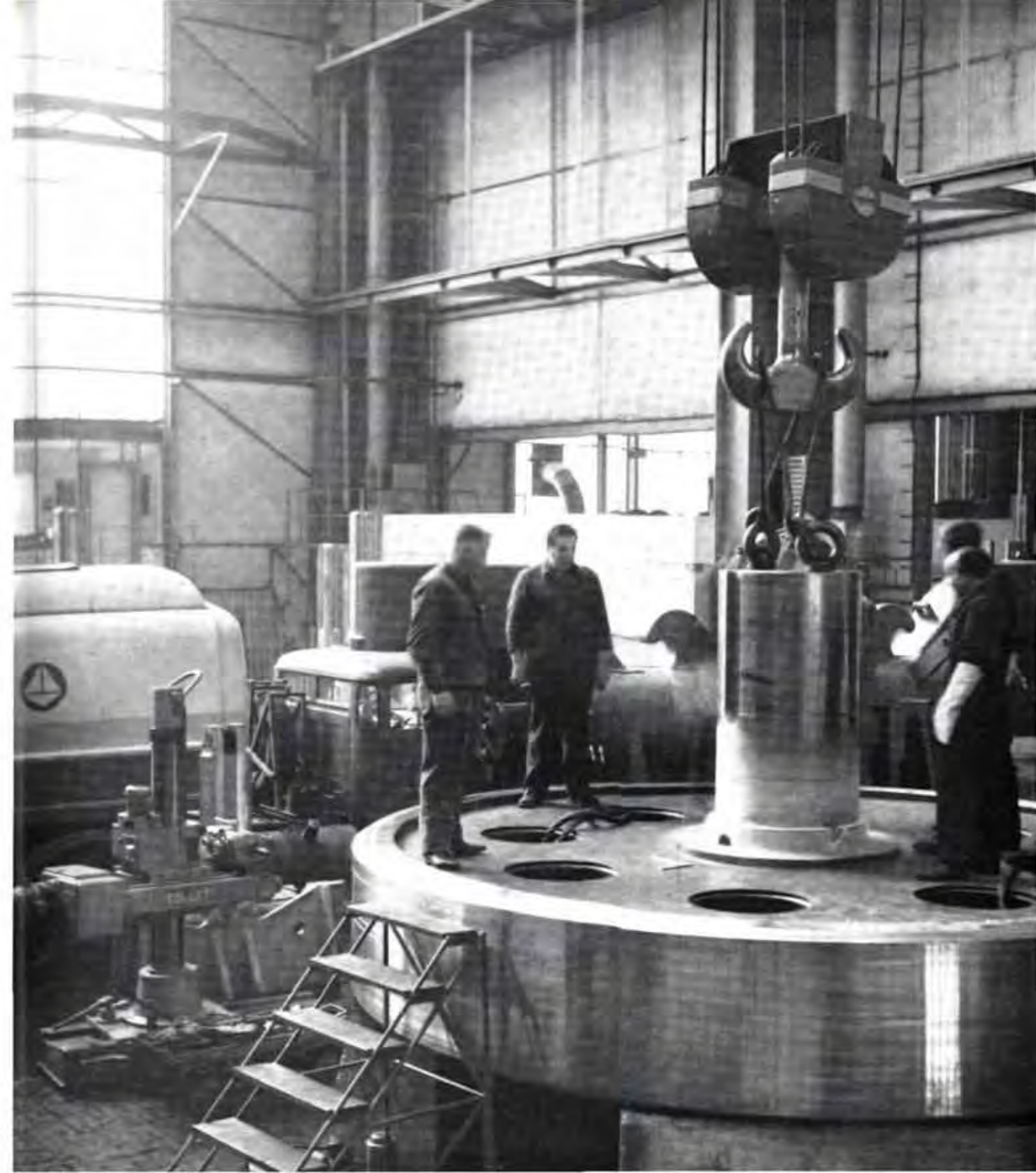
Einschrumpfen einer acht Tonnen schweren Welle durch Unterkühlen mit flüssigem Stickstoff.
