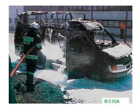
Eine undichte Acetylengasflasche hat sich in einem Lieferwagen am Flaschenventil entzündet. Der Fahrer konnte gerade noch entkommen. Das Fahrzeug brannte in nur zwei Minuten aus.
